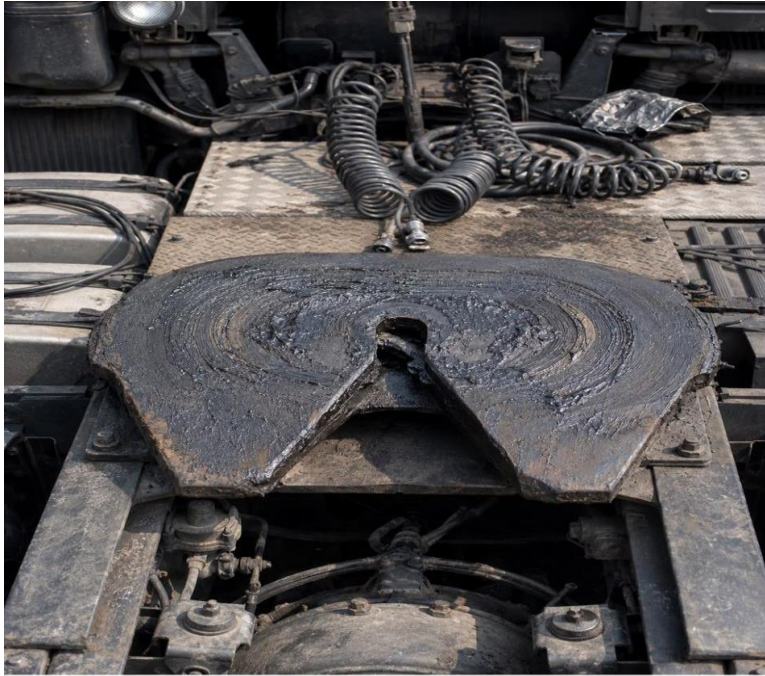
Fifth wheel — titik paling berbeban pada sambungan tractor-trailer
