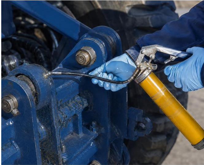
Pelumasan titik dengan grease gun — uji harian yang sederhana
