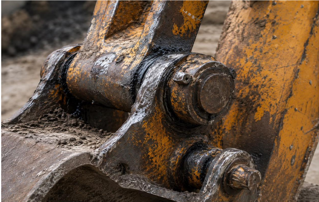
Pin dan bushing bucket — titik paling berbeban
